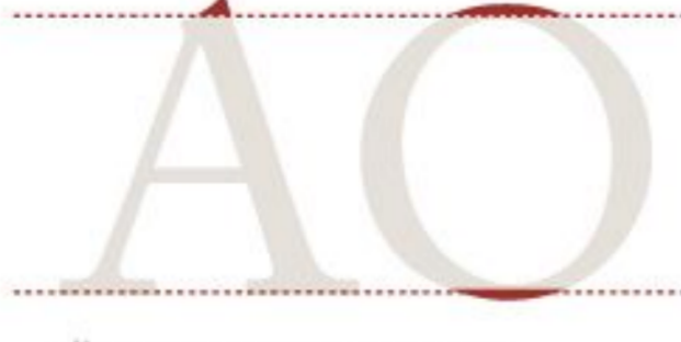
Überhang / Overshoot Bereich bei runden und spitzen Lettern, der über die Versalhöhe bzw. Grundlinie hinaus ragt.
